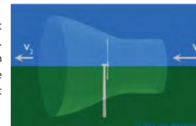
Figure 129 : Modification du vent au passage d'une éolienne 131
